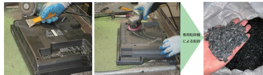
キャビネットの異物(ラベル、金属等)除去作業
