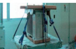
برج اختبار الارتفاع ٤٠ م لقياس قوة أداء الكومبرسورات
