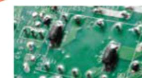
室外機の制御基板には、耐久性に配慮して、両面コーティングをしています。
