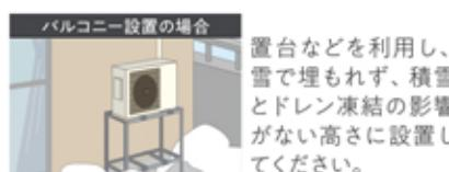
置台などを利用し、雪で埋もれず、積雪とドレン凍結の影響がない高さに設置してください。
